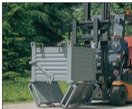
Inicio del cierre ayudado por los rodillos de acero
