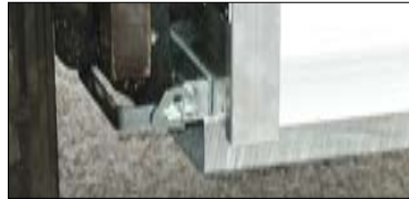
Anclaje de seguridad.
