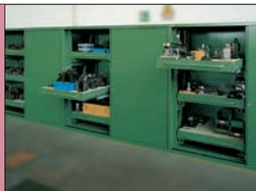
Estante de chapa con rebordes H mm 20 en los 4 lados y cobertura de madera multiplex de 12 mm
