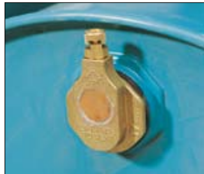
Art. 117-131 Válvula de seguridad. Rosca 2". Presión de apertura 0,35 bar.
