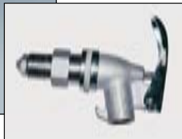
Art. 117-134 Grifo en latón con cierre automático. Rosca 2" y junta de teflón. Para líquidos con viscosidad >SAE 30.
